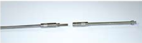
Une fois le test de salissure inséré, visser les 2 parties du « Lumcheck »
