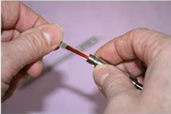
Insertion du test de salissure dans l'accessoire « Lumcheck »
