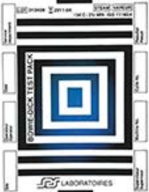
ECHEC Traces bleues au centre de la feuille test
