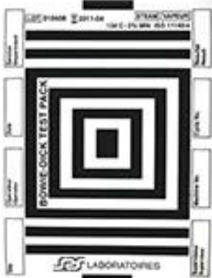
Virage au noir Uniforme Résultat CORRECT
